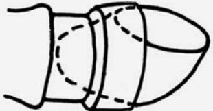
Diminuer et creuser la mousse de sorte que l'emboîture soit insérée à l'intérieur à la longueur désirée. Fixer l'emboîture avec de la colle. S'assurer que l'emboîture de la main est bien positionnée.
